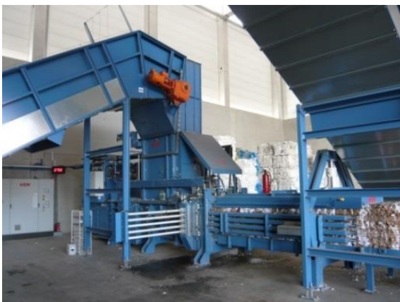
Abbildung 3: Sortieranlage und Kanalballenpresse Deißlingen
