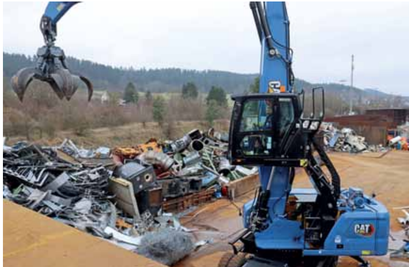
Ein neuer Cat Umschlagbagger MH3026 beschickt die 800 Tonnen starke Schrottpresse.
